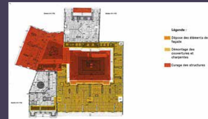
Plan masse avec indication des démolitions, 2017 et 2023.
