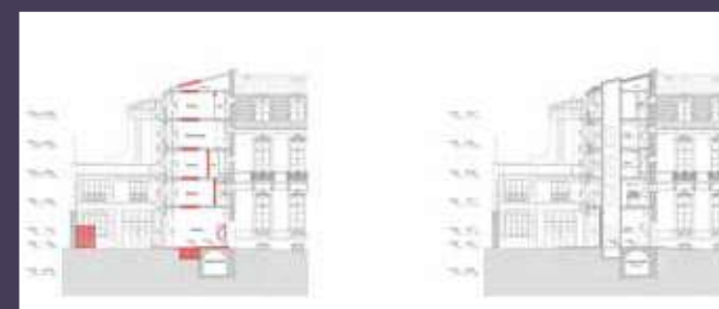
Coupe, état existant et projet d'installation d'un ascenseur (© De Portzamparc architecte / Renaissance architectes / A5A architectes).
