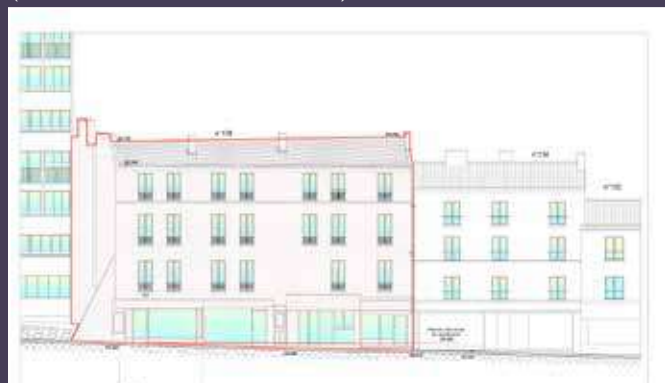
Élévation de la façade sur rue, état existant présentant les démolitions envisagées (© Cabinet Lebrun Architecture).
