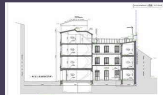
Coupe longitudinale, état existant (© B. architecture).
