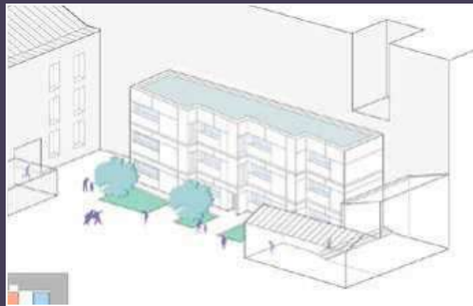
Vue axonométrique depuis le fond de cour, hypothèse n° 1 pour la reconstruction du bâtiment à R+2 (© Fortier / Vega arch.).
