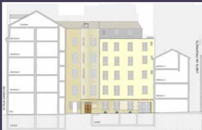
Élévation du front latéral sur cour, état projeté, faisabilité, janvier 2023 (© MBF Associés).
