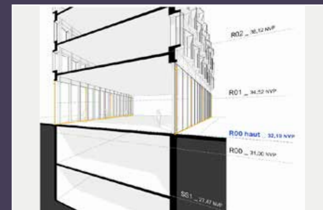
Ci-contre : projet de rehaussement du plancher du rez-de-chaussée avec démolition de façade et du plancher supérieur, versions A et B (© Cro&Co architecture).
