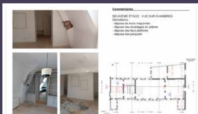
Projet de démolitions, 2 e étage (© Perrot Richard).
