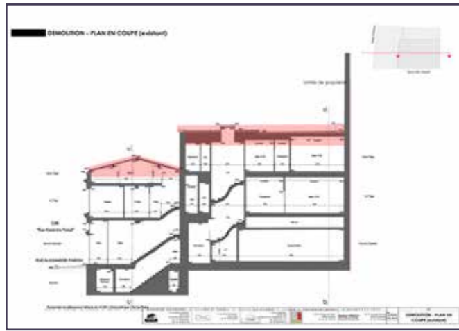
Coupe, état existant et démolitions (© Virtuel Architecture).
