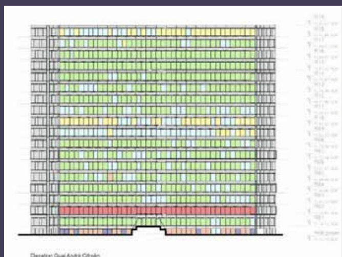
Historique des vitrages, en rouge, bleu et orange les vitrages d'origine (estimés à 3%) (© Cro&Co architecture).
