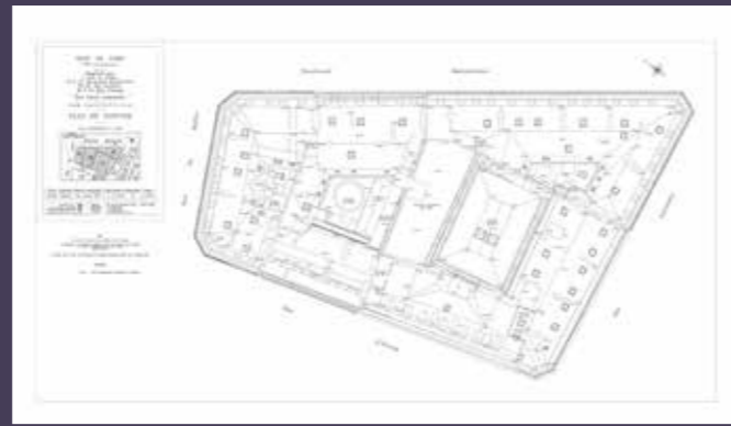
Plan des toitures, état actuel (© Legrand géomètres).
