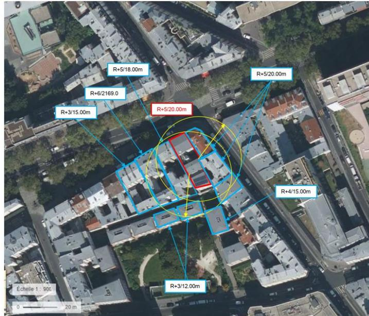
**Simulation et conformité au seuil de la Charte en 2G/3G/4G/5G (2100 MHz) - Faisceau fixe**
