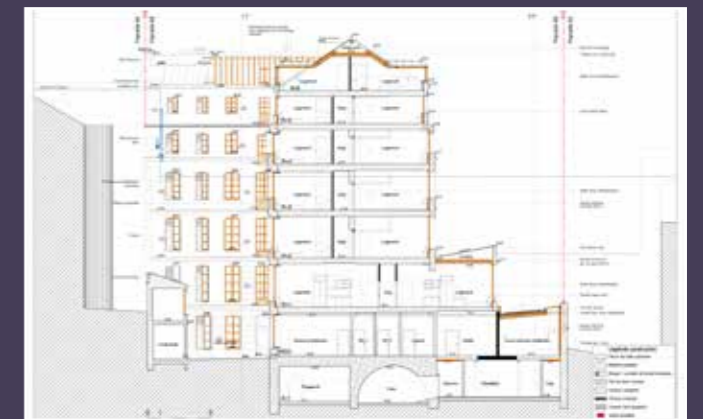
Coupe BB', état projeté (© Prinvault architectes).
