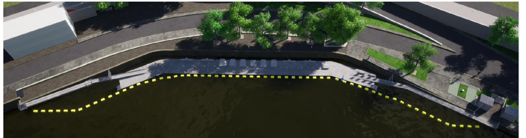
Vue axonométrique du site de baignade lorsqu'il est fermé au public. La ligne d'eau de sécurité est détendue et ramenée le long du ponton de baignade. L'emprise du chenal de navigation est totalement libérée.
