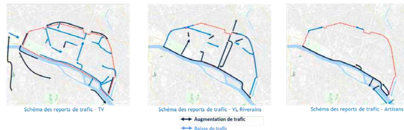
Figure 26 : Schéma des reports de trafic entre le scénario Projet et le Fil de l'Eau pour les différents types de véhicules durant la PPM
