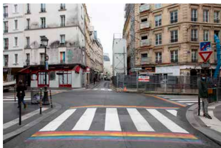
Figure 103 : Accessibilité PMR facilitée par de larges trottoirs et par des bandes podotactiles, rue de la Verrerie (4 ème ) – Crédit : C. Belin / Ville de Paris
