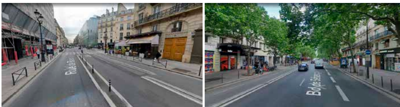
Figure 108 : Piste cyclable bidirectionnelle et voie bus sur la rue de Rivoli (1 er , à gauche) ; piste cyclable bidirectionnelle le long du boulevard de Sébastopol (1 er , à droite) – Google Street View
