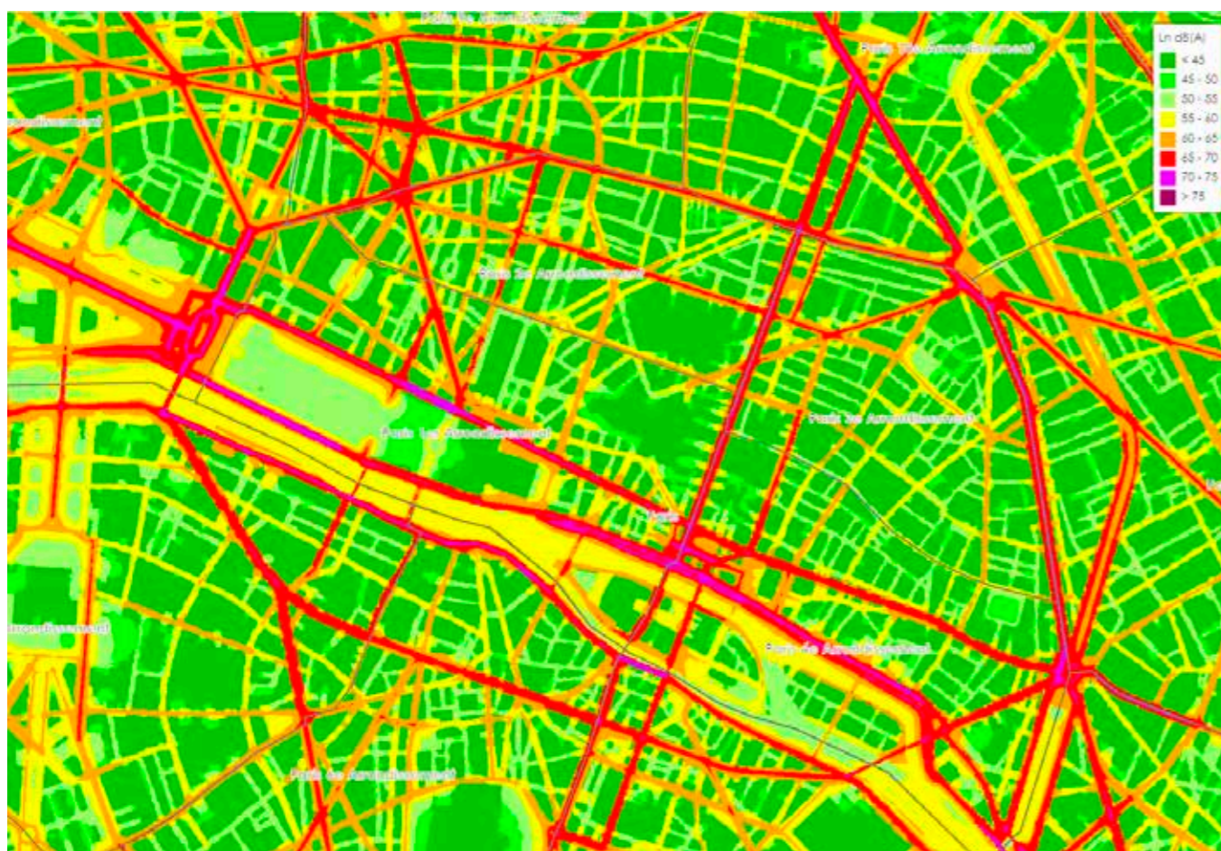
Figure 13 : Cartes du bruit des transports routiers, ferroviaires et aériens nuît – source : BRUITPARIF
