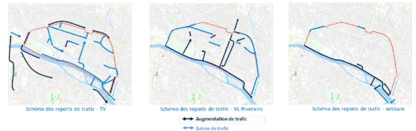
Figure 64 : Schéma représentant les reports de trafic entre le scénario projet et la référence pour les différents types de véhicules durant la PPM (TV = Tous Véhicules ; VL = Véhicules Légers)
