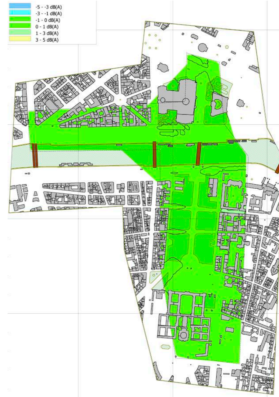
Différences des cartes de bruit de l'état projeté et « fil de l'eau », en période diurne (6h-22h)
