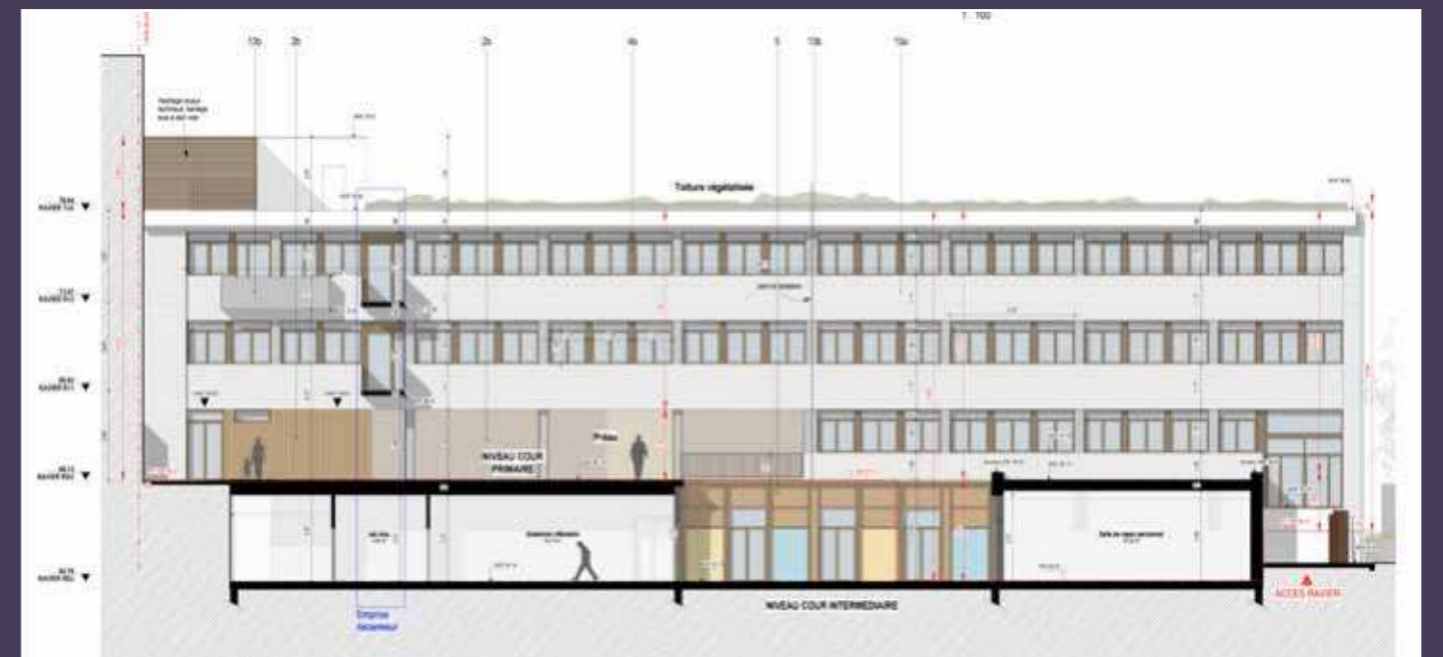
Élévation du bâtiment Ravier, état projeté avec pose d'ITE et création d'une terrasse végétalisée (© AUP/Architectes).
