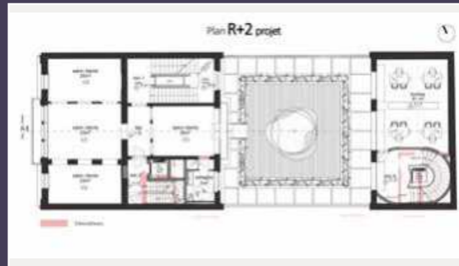
Plan du deuxième étage, état projeté avec indication en rose des démolitions envisagées (© Moatti - Rivière).
