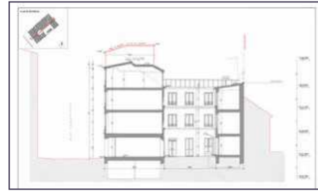
Coupe longitudinale, état existant (© Savoir-Fair Architecture).
