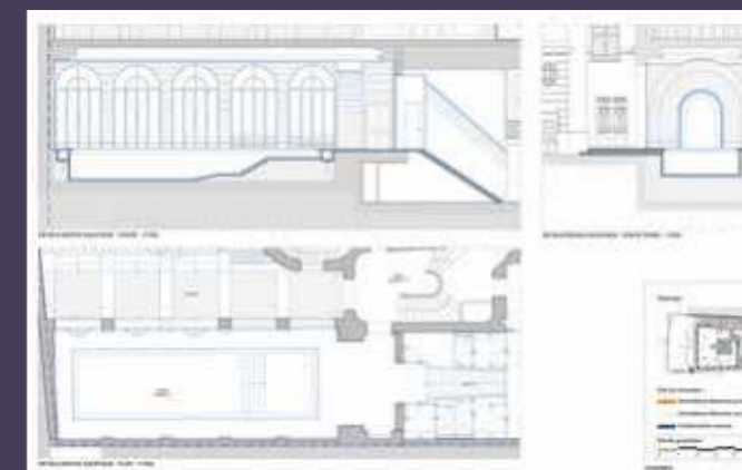
Détails sur l'espace aquatique, coupes et plan, état projeté (© LBBA Architecture).
