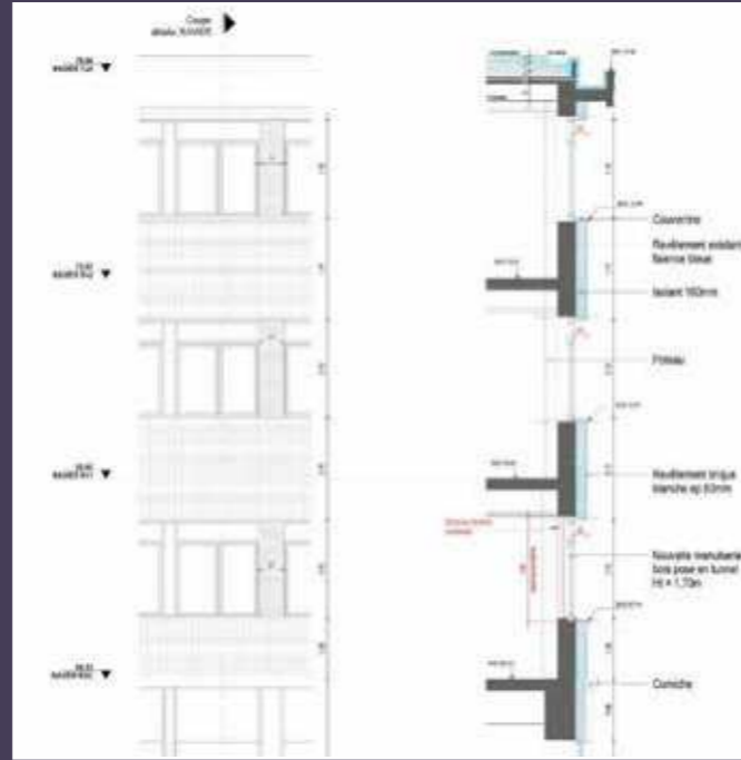
Schéma présentant le détail de la pose de l'ITE pour la façade du bâtiment Ravier (© AUP/Architectes).
