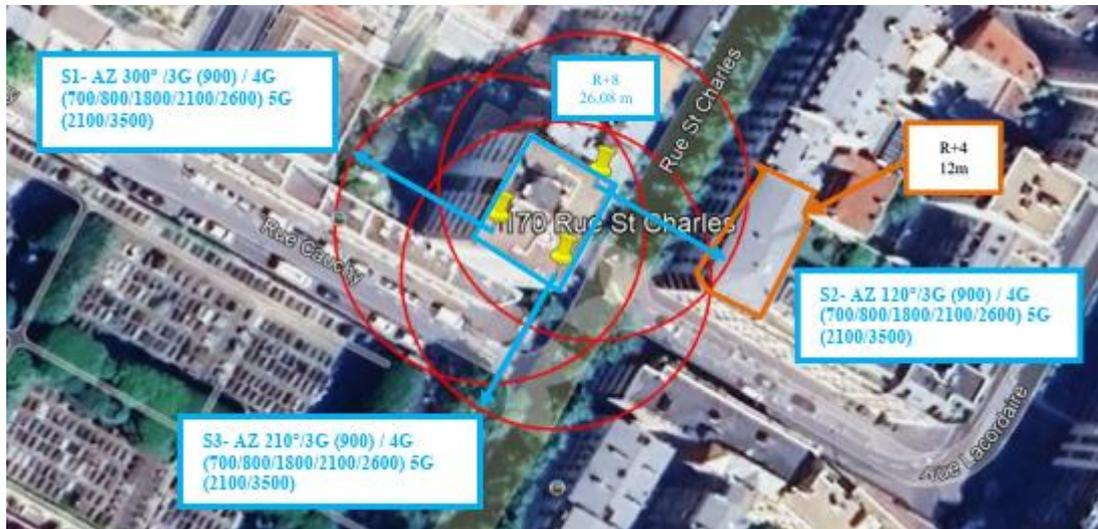
Simulation et conformité au seuil de la Charte en 3G/4G/5G (2100 MHz)
