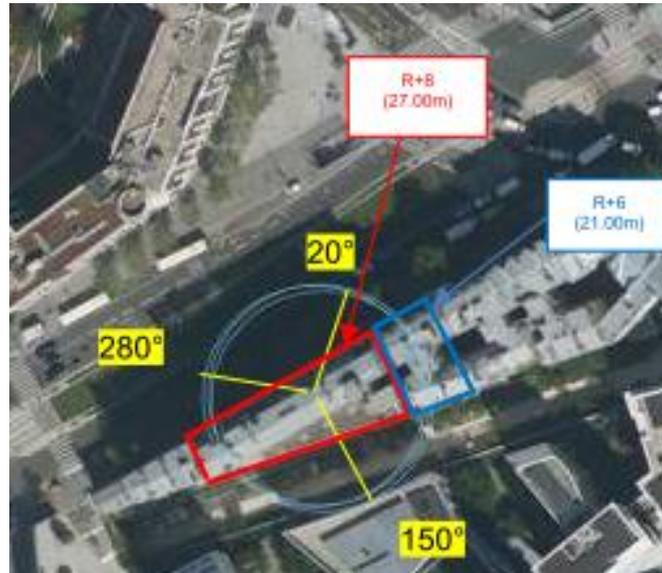
**Simulation et conformité au seuil de la Charte en 3G/4G/5G (2100 MHz) - Faisceau fixe**
