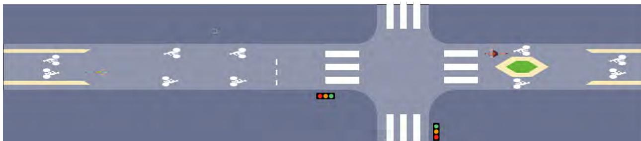
Lorsque la largeur de chaussée circulaire le permet, on met en place des marquages pour le DSC et une bande cyclable (côté circulation générale).
