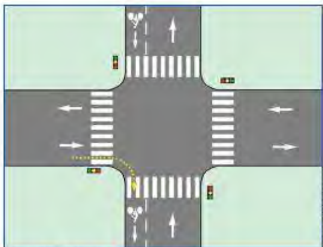
Schéma 3 : Entrée sur une bande cyclable
