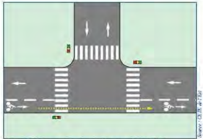
Schéma 7 : Mouvement direct sur double sens cyclable (DSC)
