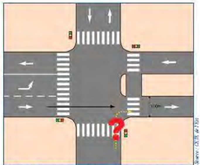
Schéma 9 : tourne-à-droite sur une voie étroite ou avec rétrécissement ponctuel en sortie de carrefour
