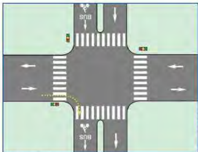
Schéma 4 : Entrée sur voie bus ouverte aux vélos
