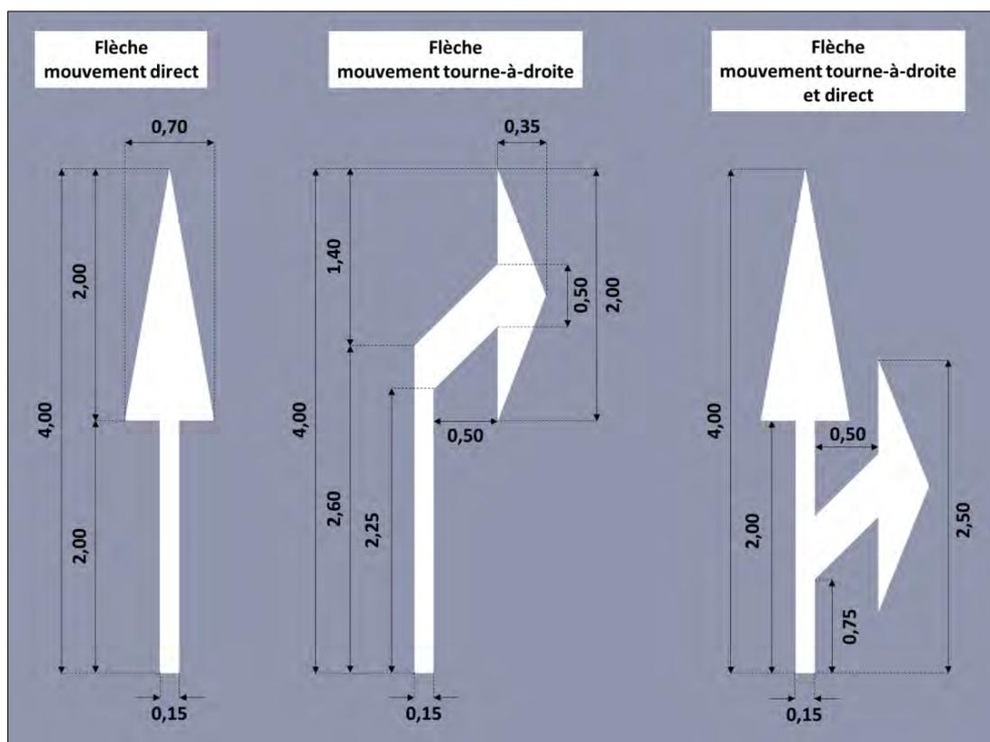
Les flèches de "tourne à gauche" et de "tourne à gauche et direct" se déduisent par symétrie respectivement des flèches de "tourne à droite" et de "tourne à droite et direct".
