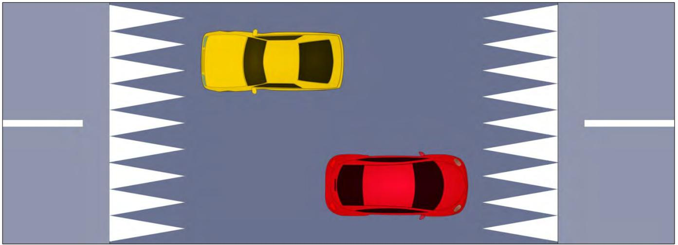
La réalisation d'un passage pour piétons au niveau du plateau n'est nécessaire que si l'importance du trafic nécessite une canalisation des piétons.
