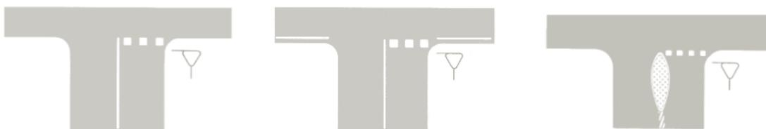
On veille à positionner la ligne de cédez-le-passage en limite de chaussée, c'est-à-dire à la bordure de trottoir des voies traversantes.
