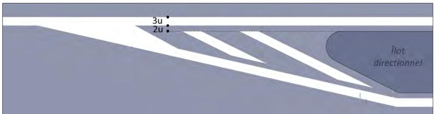
Les annonces de bornes et refuges sont matérialisées sous forme d'un triangle sur 10 fois la largeur de l'îlot (par exemple : 15,00 m pour des socles Devault de 1,50m).
