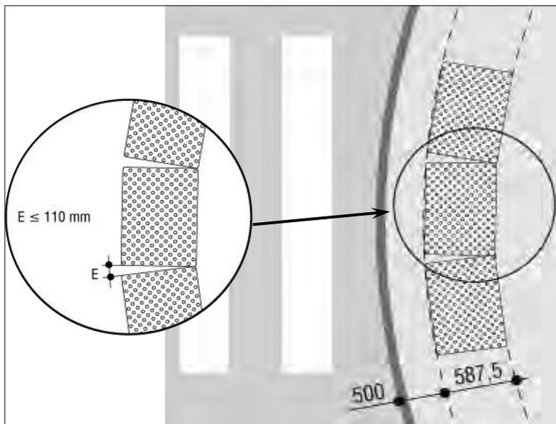
➤ **Format de bande en fonction des largeurs de trottoir (mesures prises depuis la limite de la chaussée)**
