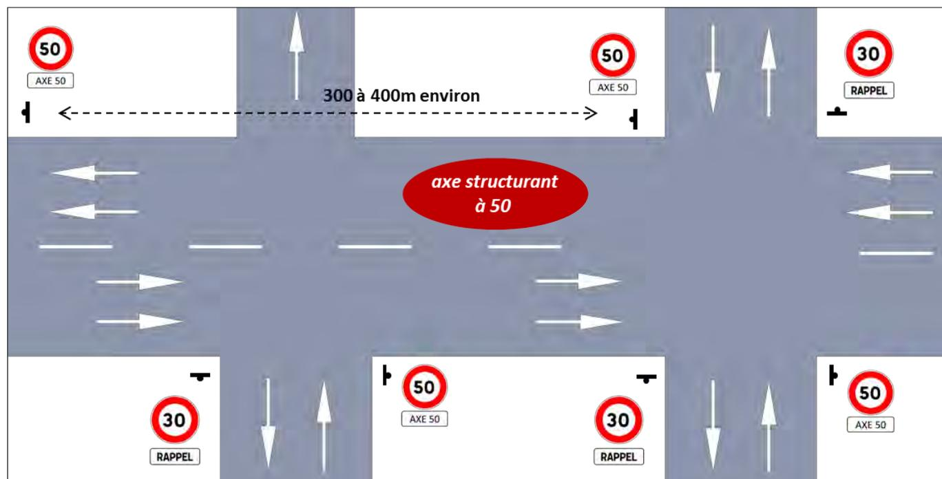
Exemple de traitement des bretelles d'accès ou de sorties des axes à 50 :
