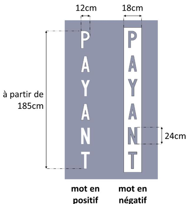
Le modèle en négatif a une résistance à l'usure nettement supérieure dans le temps. Il faut éviter de panacher ces deux modèles de marquage sur une même voie.
