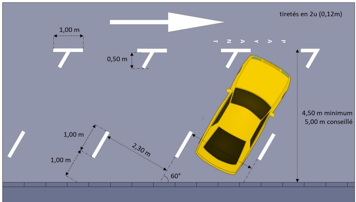
*même schéma de principe pour un angle de 45°*
