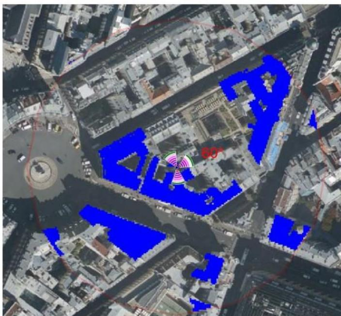
Les simulations en espace libre avec bâti simple vitrage indiquent les niveaux maximums en intérieur par antenne à faisceaux orientables :
