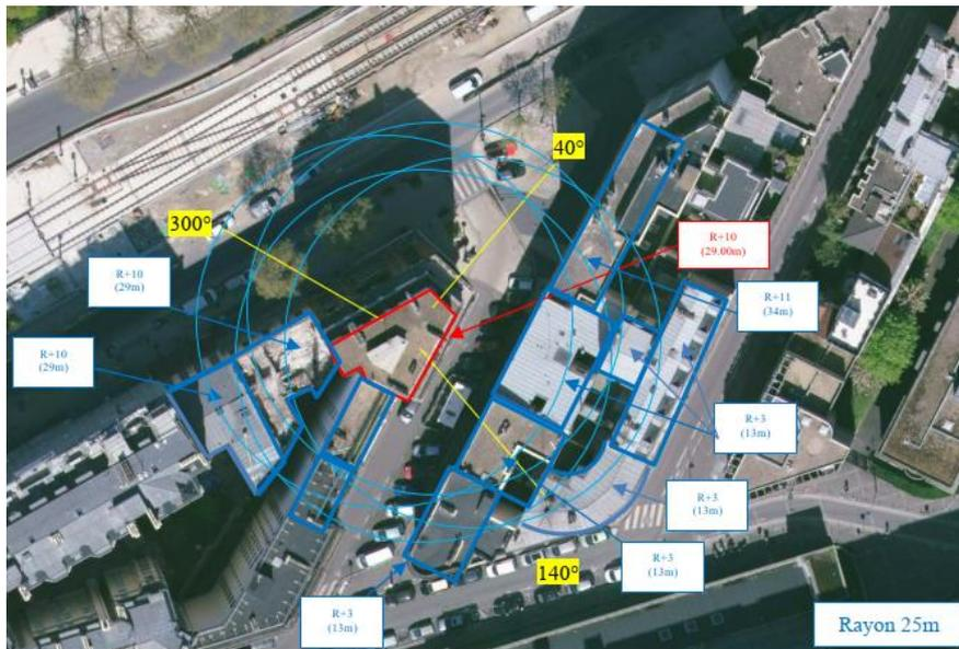
Simulation et conformité au seuil de la Charte en 2G/3G/4G/5G (2100 MHz) - Faisceau fixe
