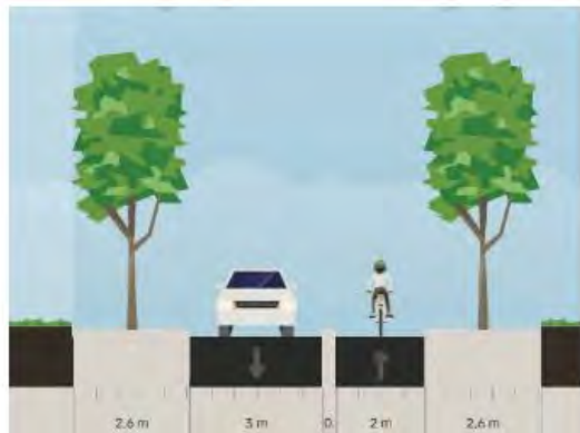
Alignement discontinu côté pair (présence de l'égout en sous-sol)
