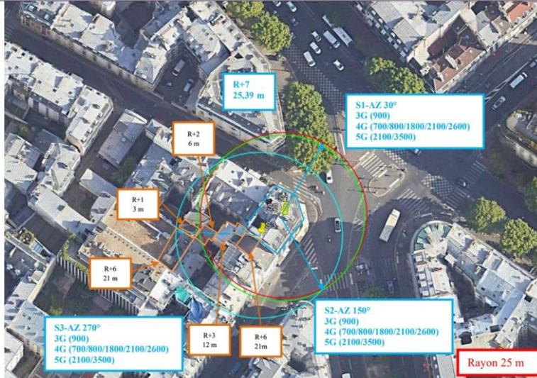
Simulation et conformité au seuil de la Charte en 3G/4G/5G (2100MHz)
