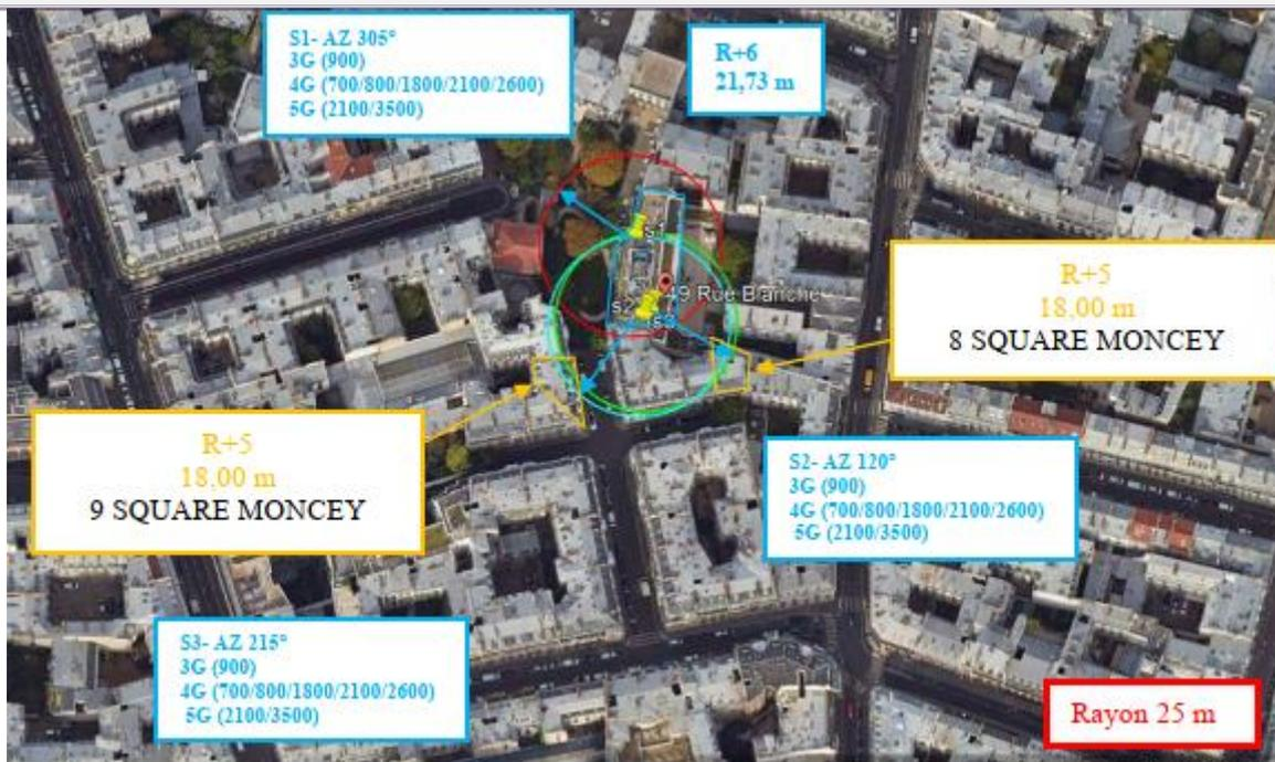
**Simulation et conformité au seuil de la Charte en 3G/4G/5G (2100 MHz)**
