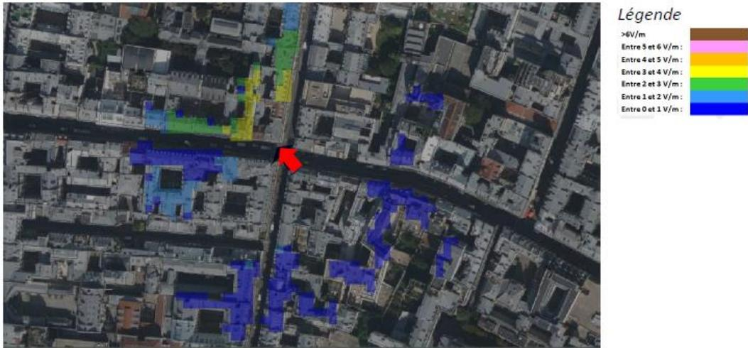
**Simulation et conformité au seuil de la Charte pour le 3500MHz (5G) - Faisceaux orientables**
