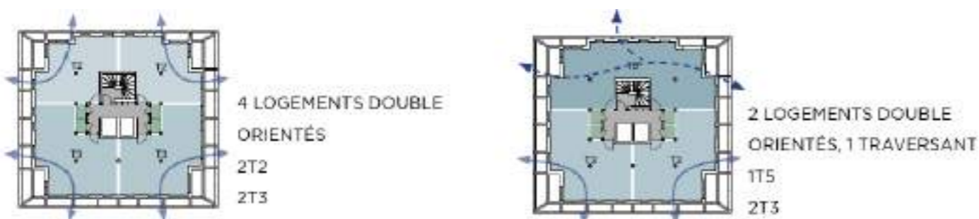
Ventilation naturelle sur le bâtiment F – Petit Didier Prioux
