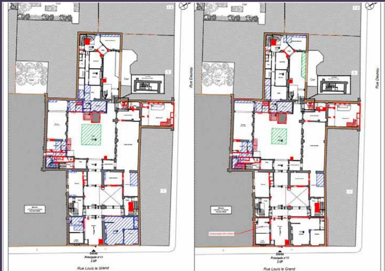
Plans de démolition du rez-de-chaussée. À gauche, projet présenté dans le cadre du PC. À droite, celui du PCM, octobre 2024 (© YMA architectes).
