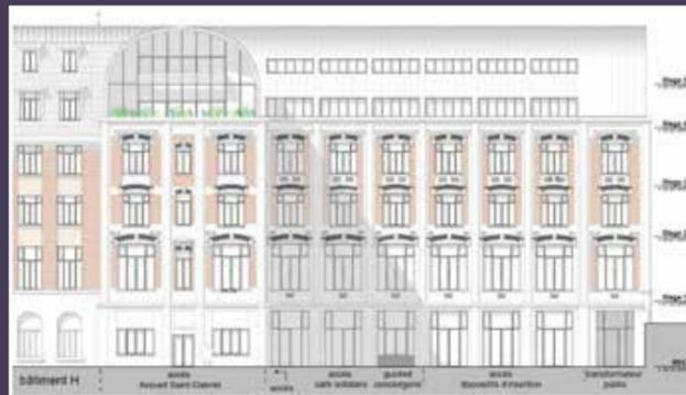
Élévation avec surélévation du bâtiment I, 2024 (© ChartierDalix et Hardel Le Bihan).
