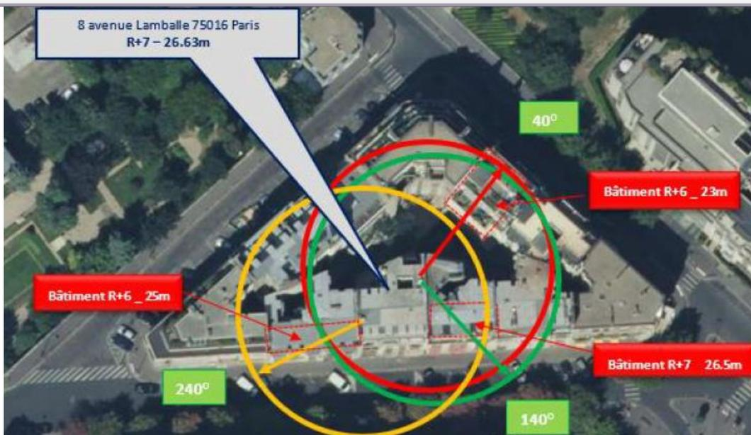
**Simulation et conformité au seuil de la Charte en 2G/3G/4G/5G (2100 MHz)**
