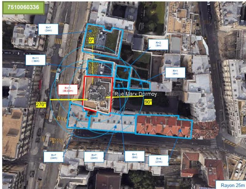
**Simulation et conformité au seuil de la Charte en 3G/4G/5G (2100 MHz) - Faisceau fixe**
