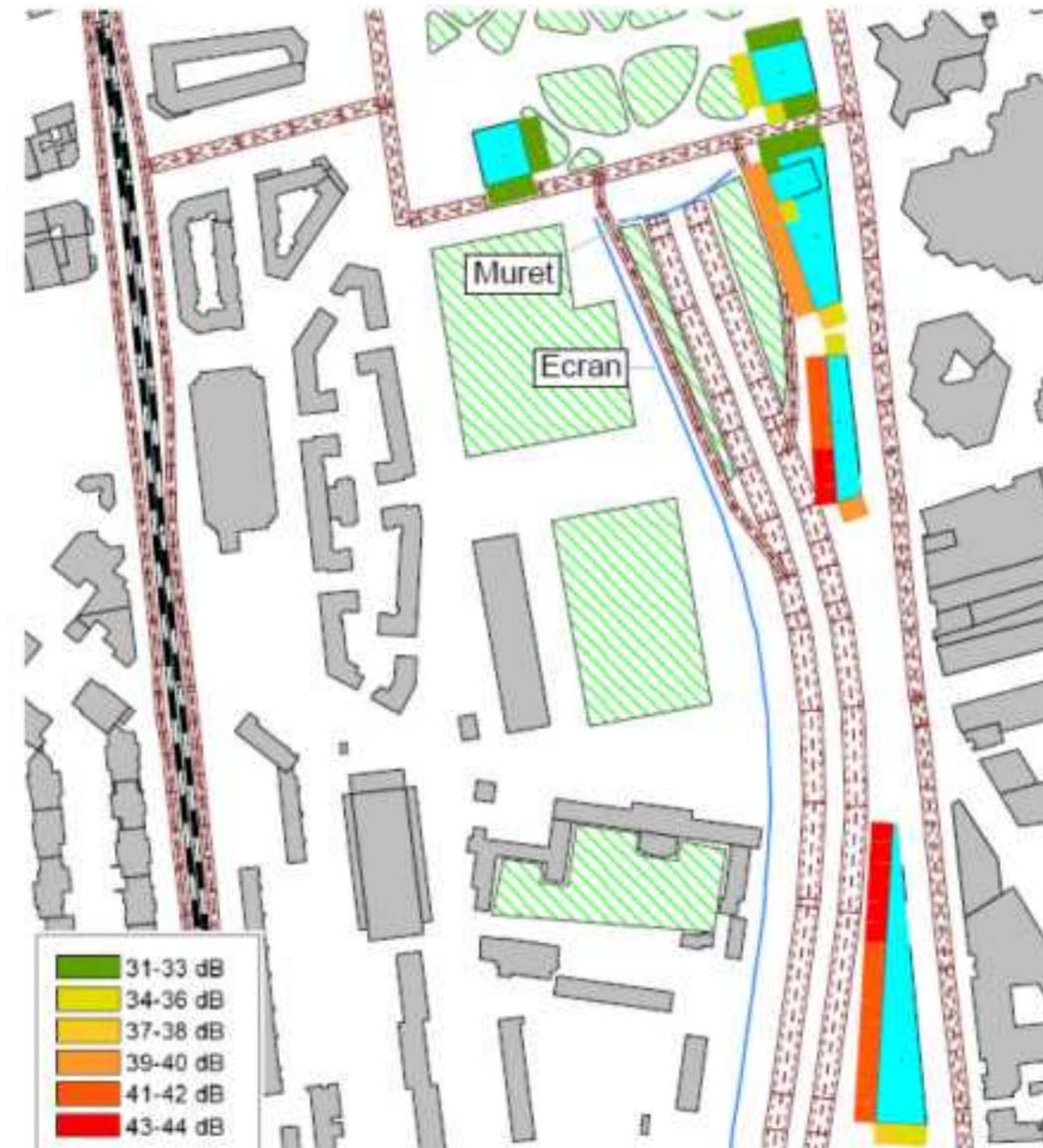
Figure 17 : Visualisation des isolements acoustiques minimaux supérieurs à 30 dB(A) requis par le classement sonore des voies et les voies nouvelles. Source : Etude acoustique de la Porte de Montreuil. Gamba.
