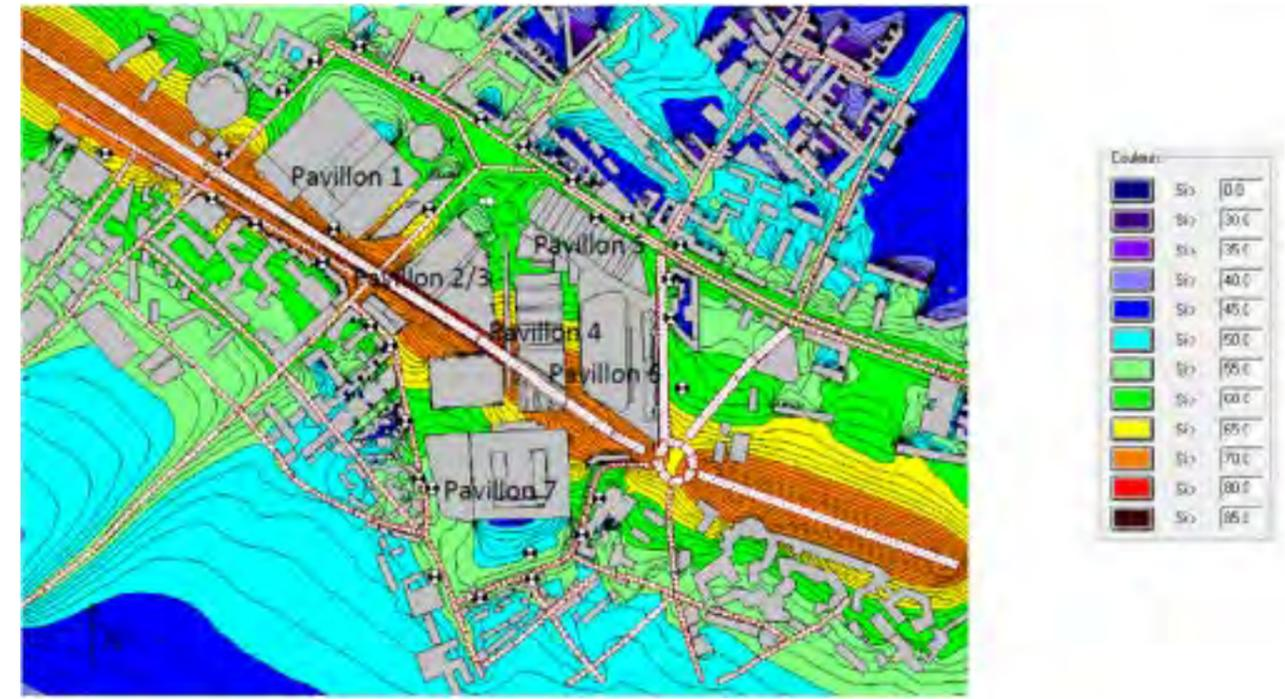
Figure 66 : Cartographie du niveau de pression sonore (dB(A)), période nocturne long terme (fin de la phase 3 – 2029) (Source : Cabinet Lamoureux, 2024)
