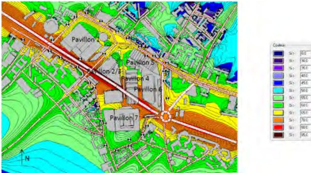
Figure 64 : Cartographie du niveau de pression sonore (dB(A)), période diurne long terme (fin de la phase 3 – 2029) (Source : Cabinet Lamoureux, 2024)
