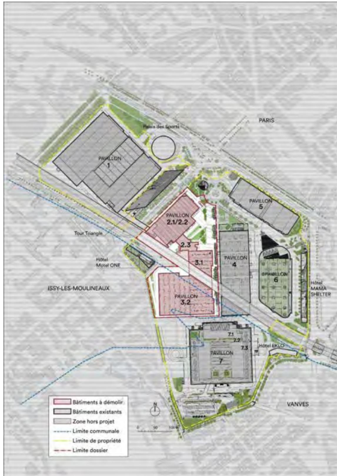
Figure 19 : Repérage des phases de travaux du projet de modernisation du Parc des Expositions (Source : Valode et Pistre)
