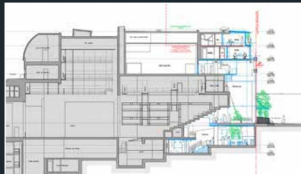
Coupe avec modification de comble et modifications de plancher, 2025 (© Du cœur à l'ouvrage).
