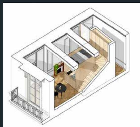
Système de cloisons meubles pour installer des logements à l'étage noble du n° 39 (© Agence 2BDM Architectes).
