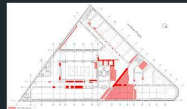
Plan des démolitions, rez-de-chaussée (© CALQ Architecture).
