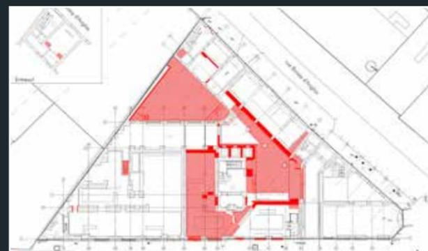
Plan des démolitions, sous-sol (© CALQ Architecture).
