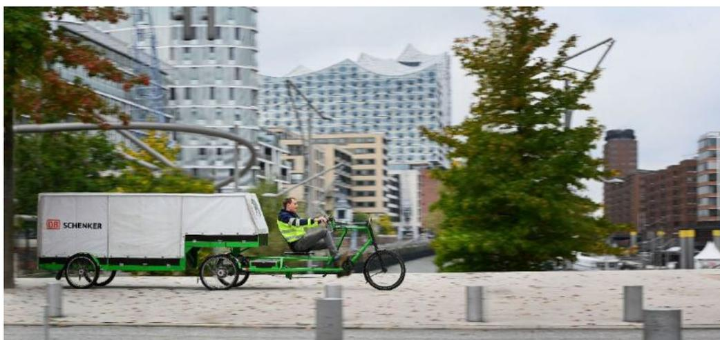
Figure 23 : Vélo cargo XXL pouvant porter jusqu'à 500 kg (© DB Schenker / Max Lautenschläger)
