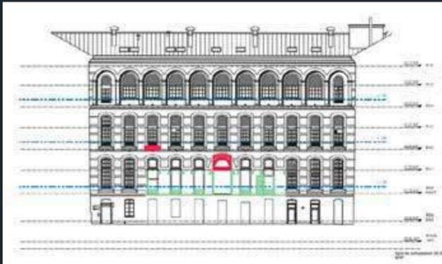
Modification d'allèges et d'ouverture de la façade historique pour le raccordement avec les pavillons d'extension (© Barthélémy Griño, Valero Gadan, Goutal & Clément).
