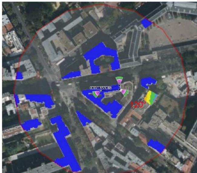
Les simulations en espace libre avec bâti simple vitrage indiquent les niveaux maximums en intérieur par antenne à faisceau fixe :
