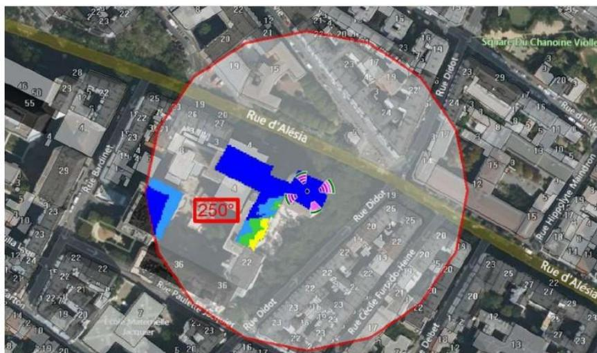
Les simulations en espace libre avec bâti simple vitrage indiquent les niveaux maximums en intérieur par antenne à faisceau fixe :
