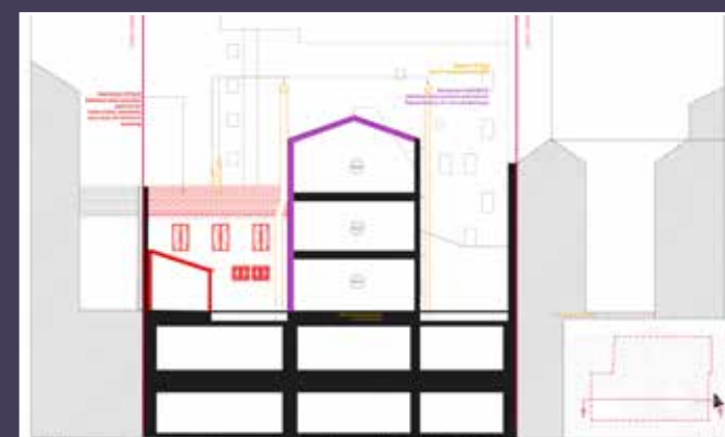
Coupe, façade nord, état existant présentant les constructions à démolir, projet présenté en janvier 2024 (© ID d'architectes).
