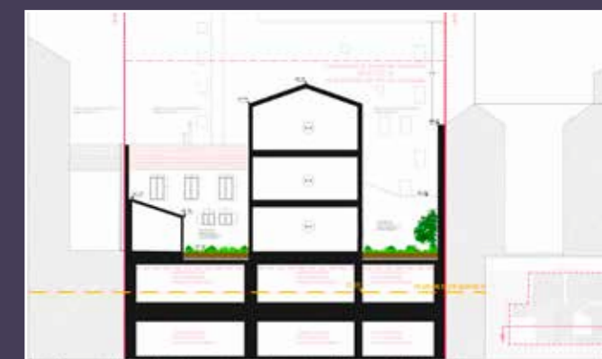
Coupe, façade nord, nouveau projet (© ID d'architectes).
