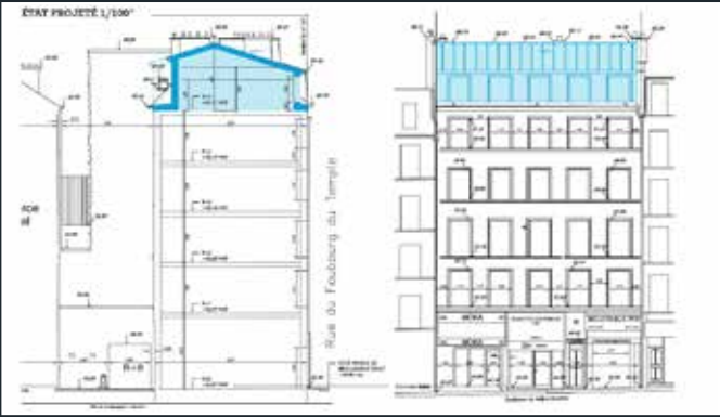
Coupe et élévation de la façade, projet présenté en avril 2025 (© Équator Paris Architecture, Félix Millory Architecture).
