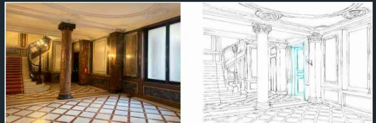
Projet de transformation de l'un des vestibules avec dépose de panneaux de marbre (© LBBA architecture).
