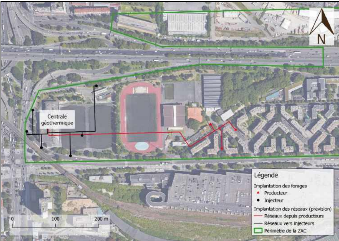
Figure 41 : Cheminement prévisionnel des réseaux depuis les puits de production jusqu'au puits de réinjection
