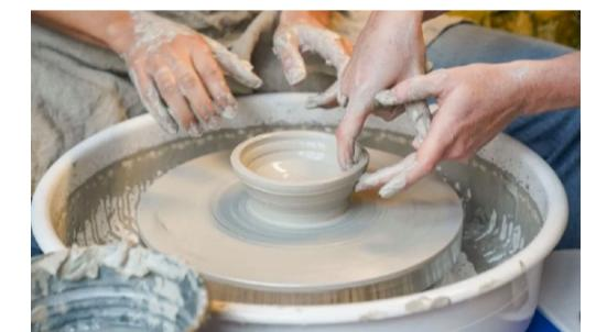
La réalisation d'un objet en céramique suit un ensemble d'étapes successives, depuis la préparation de la matière jusqu'à la cuisson finale. Le matériau de base est l'argile, une roche sédimentaire composée principalement de silicate d'alumine, de magnésie et d'eau. Les principales étapes du processus sont les suivantes :
