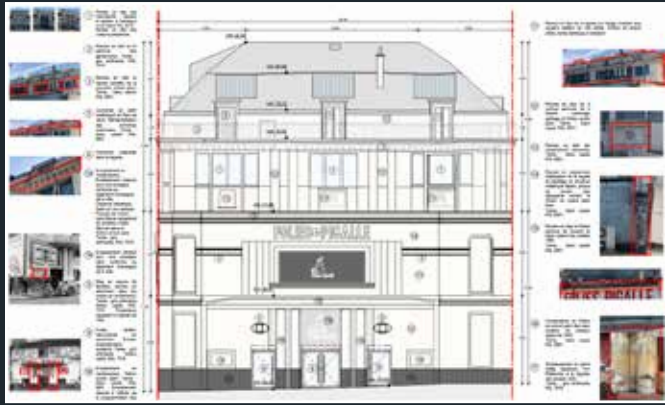
Élévation projetée côté place avec détail des reprises et des interventions, 2025 (© Rolinet & Associés).
