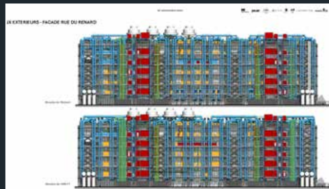
Élévation de la façade rue Renard, existant et projet avec modification des réseaux, 2025 (© AIA Life Designer).
