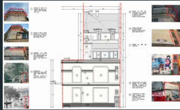
Élévation projetée côté rue Duperré avec détail des reprises et des interventions, 2025 (© Rolinet & Associés).
