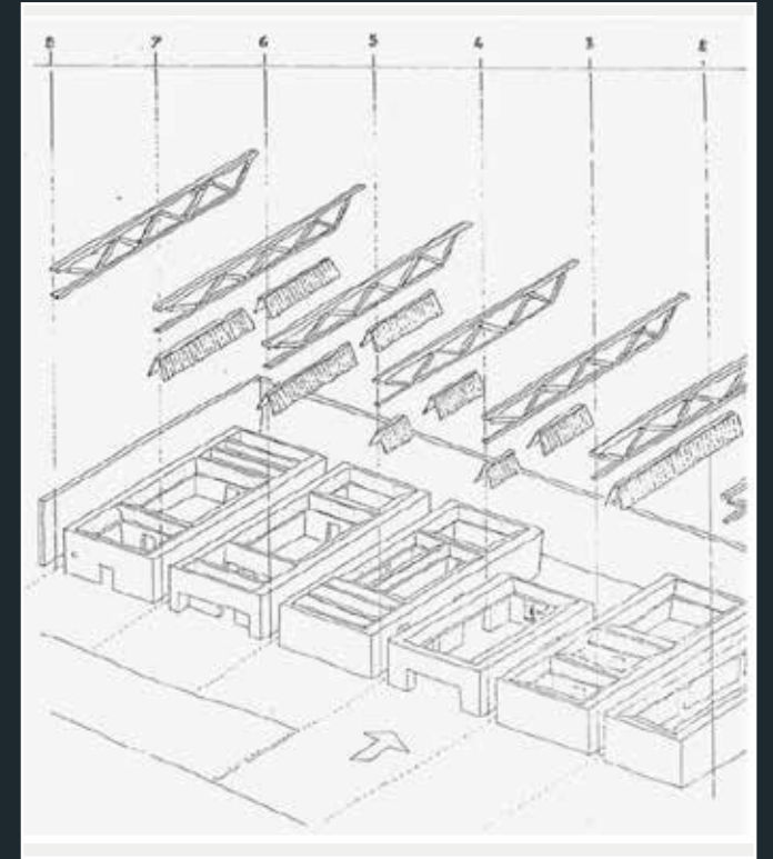
Avant-projet sommaire du réaménagement du MNAM, axonomie de l'intervention au 4 e étage avec vue éclatée des verrières, 1982, Gae Aulenti, arch. Italo Rota et Piero Castiglioni, collabs. (© Centre Pompidou).
