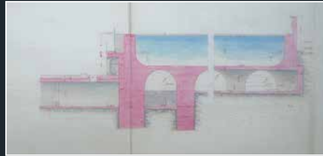
Coupe longitudinale des bassins du réservoir, dessin du 15 juin 1887 (AD75).
