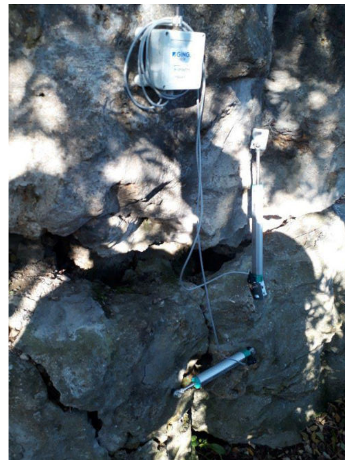
Exemple d'outils de mesure : extensomètre sur les parois de l'île : mesure l'étirement des surfaces, Ville de Paris
