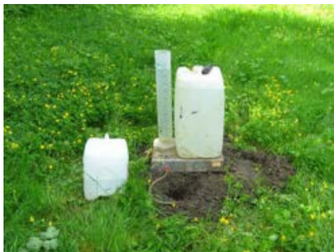
Essai de perméabilité de type Porchet
