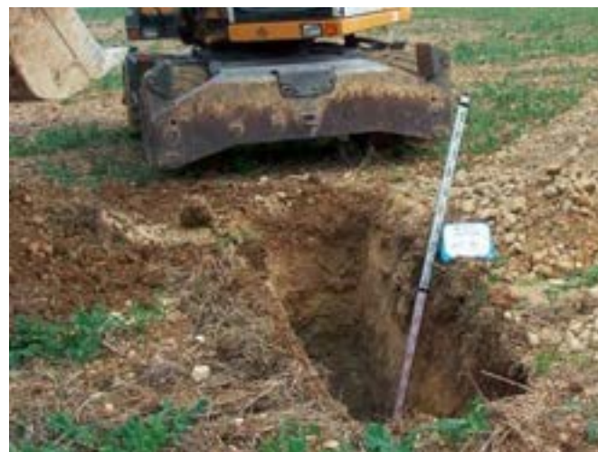
Essai de perméabilité de type Matsuo
