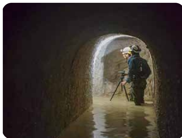
Levers topographiques d'une galerie difficilement accessible pour compléter la carte des carrières des Montalets
