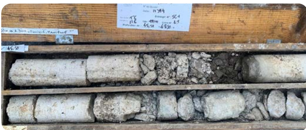
Carottes extraites d'un sondage, Paris 9e
