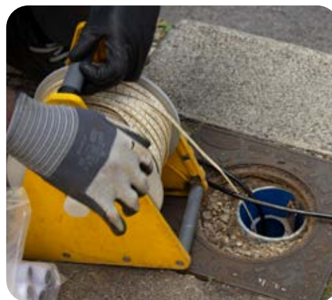
Relevé de piézomètre
