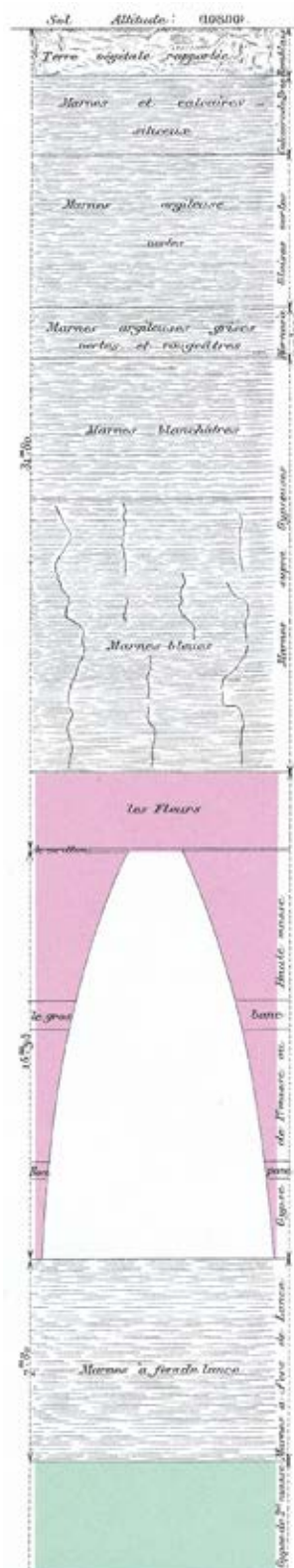
Coupe de terrain à Clichy-sous-Bois représentative de Montfermeil
