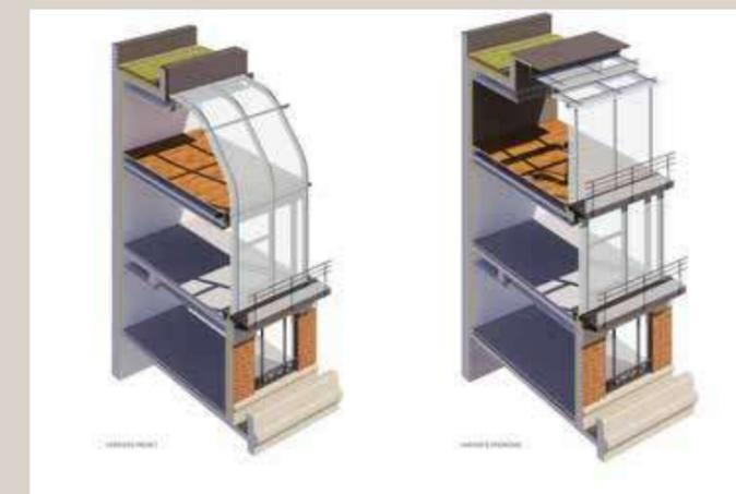
Schéma de principe pour la façade sur cour du R+7 et R+8. Projet présenté en avril 2019 (à gauche) et nouvelle proposition (à droite) (© Wilmotte & Associés).
