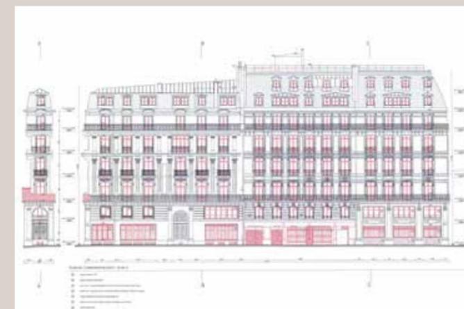
Élévation de la façade sur la rue de Provence, état existant présentant les éléments démolis (en rouge) (© Bouchaud architectes).
