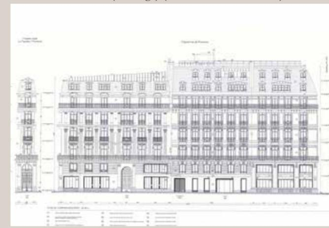
Élévation de la façade sur la rue de Provence, état projeté (© Bouchaud architectes).
