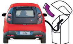
**3 REFERMEZ** doucement la trappe du véhicule. Le capot de la borne se ferme automatiquement.
