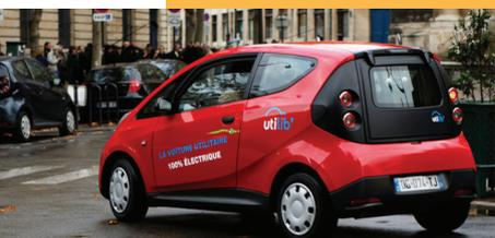
*Paris a lancé en décembre le nouveau service Utilib' à destination des professionnels. Avec 250 km d'autonomie, aux dimensions compactes - 3,65 m de long et 1,70 m de large - et optimisées pour le transport de petites marchandises - le coffre de ce véhicule en libre-service est doté d'un volume de 900 litres, qui peut supporter jusqu'à 230 kg.*
